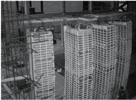
大型建筑物振动试验变形监测
